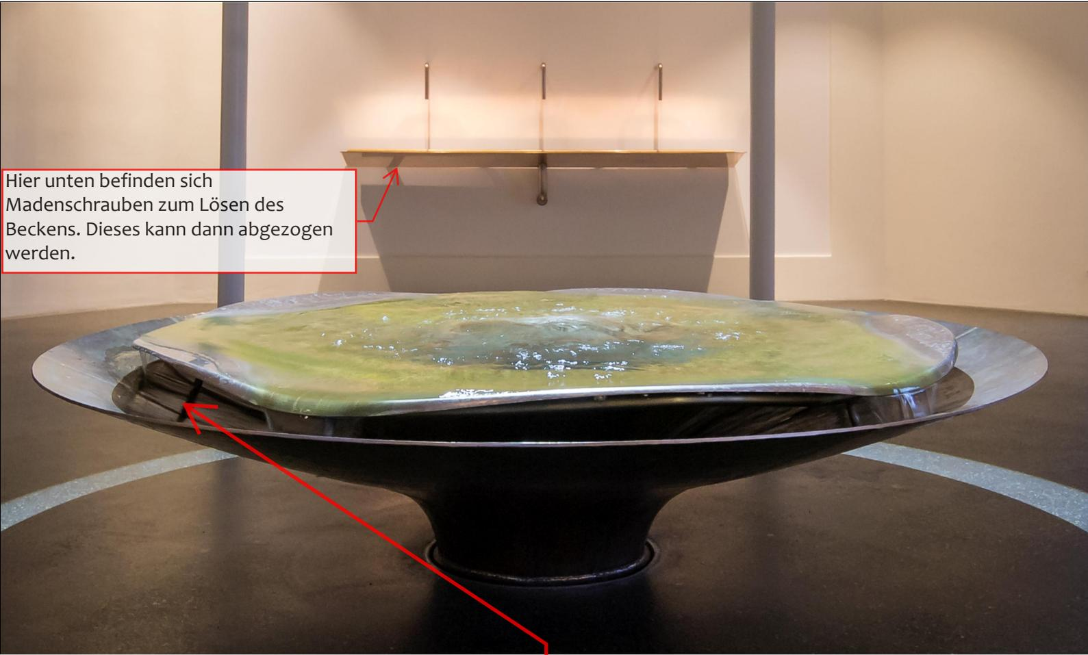
Hier unten befinden sich Madenschrauben zum Lösen des Beckens. Dieses kann dann abgezogen werden.
