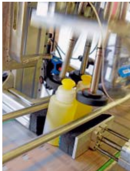
Im Führungsschlitten des Universalverschraubers reduziert ein Kleinstoßdämpfer von ACE die Aufprallgeschwindigkeit bei jedem Takt
